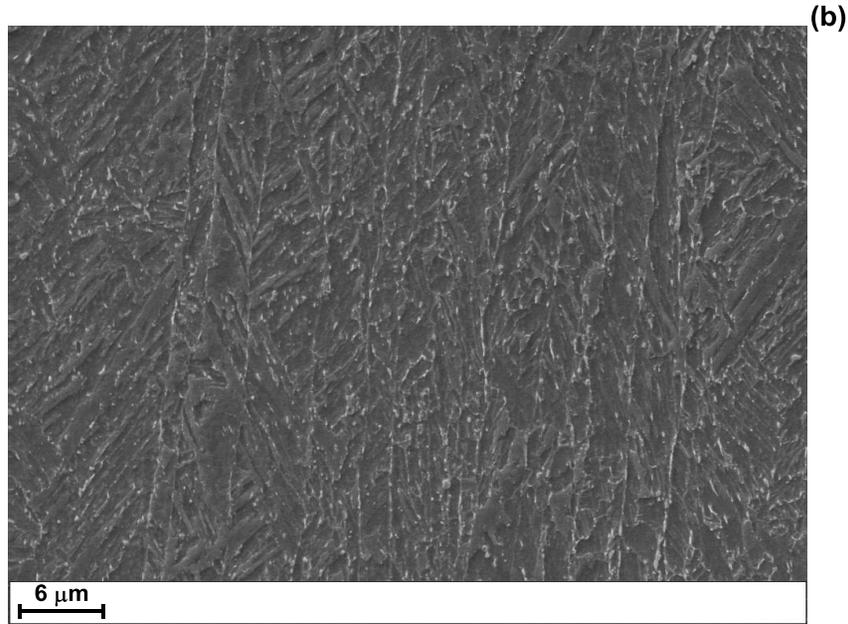
Figure 5. FESEM micrograph of 890 MPa yield strength steel plates; (a) DQ, (b) DQ+T.
