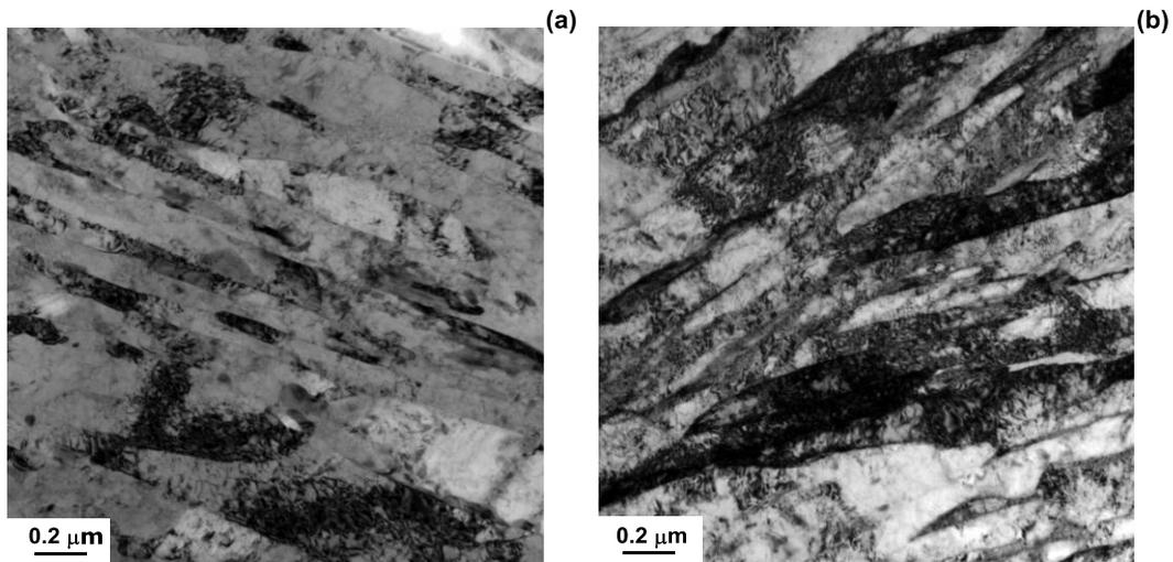
Figure 6. TEM micrographs of 1150 MPa yield strength steel plates; (a) DQ, (b) DQ+T.
