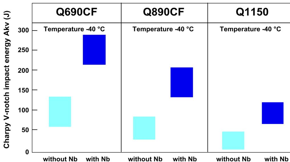
Figure 9. Effects of Nb on toughness of DQ+T high strength heavy plates.
