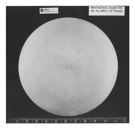
Figure 7. Macro Disk of 10" Diameter Allvac<sup>®</sup> 718Plus<sup>™</sup> Billet.
