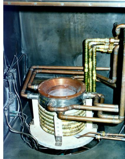
Figure 2. Bottom pour 45kg cold wall induction crucible.
